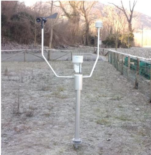
**La stazione meteo aiuta ad avere dati a disposizione ed in tempo reale grazie all'anemometro ed al pluviometro. Ad esempio, grazie all'anemometro, è possibile monitorare il deposito di foglie ed altre problematiche dell'alveo del fiume in modo da apportare gli interventi di manutenzione necessari.**
