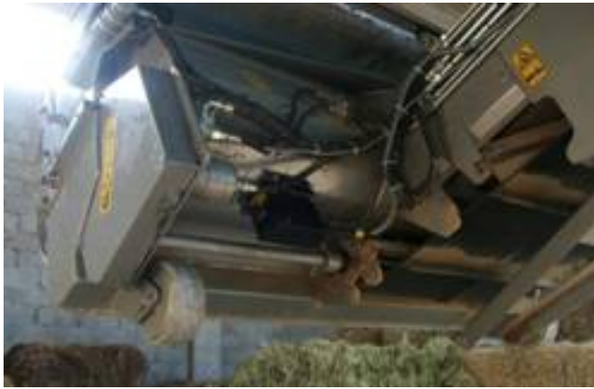
● Figura O - L'analizzatore Nir di Dinamica Generale può essere installato direttamente sulla pala del caricatore o sulla fresa del carro unifeed semovente.
