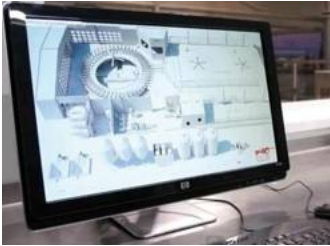
● Figura H - Una videata di "Moo System", un sistema proposto da Tecnozoo che applica alle sale di mungitura i principi della domotica. Si basa su un software in grado di gestire e controllare le singole fasi della produzione del latte.
