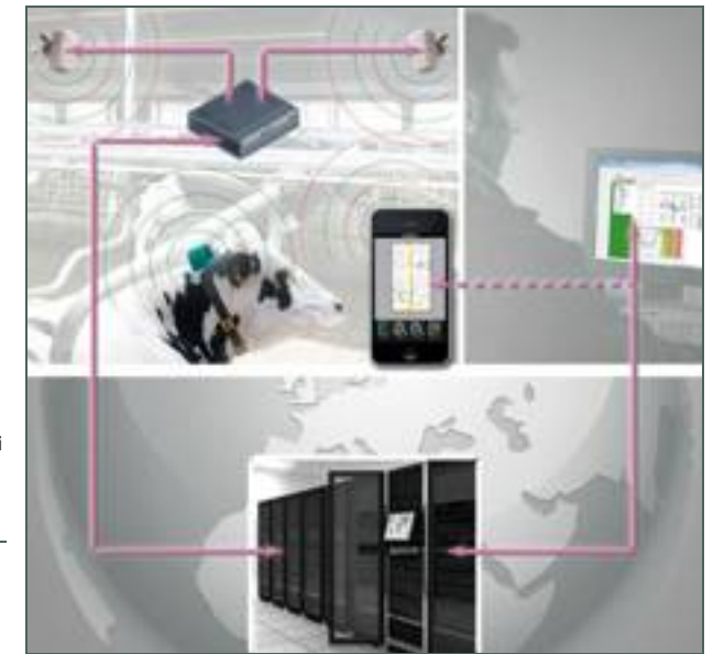
● Figura A - Schema dei flussi di informazioni che caratterizzano il sistema di monitoraggio GeaCowView.
