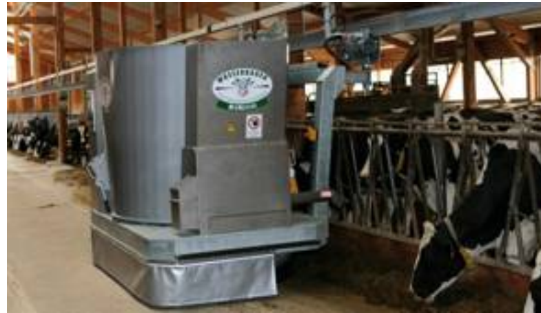
● Figura P - La principale macchina del sistema MixMeister di Wasserbauer, per la distribuzione robotizzata dell'unifeed. Grazie a una doppia pesatura la quantità di alimento da caricare e miscelare è corrispondente a quanto prevede il piano di razionamento di ogni singolo gruppo di animali.
