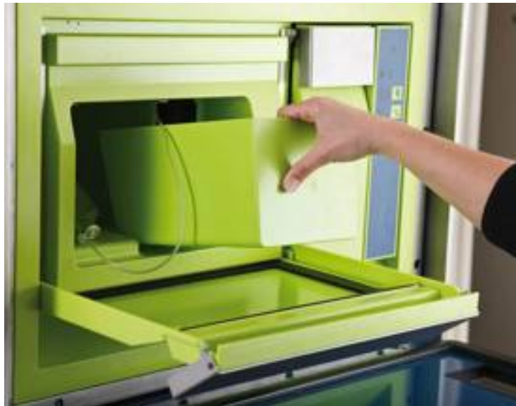
● Figura G - Il sistema di analisi del latte Herd Navigator della Delaval installato in un robot di mungitura.
